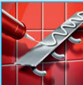
**Hinweis:** Bei absehbar auftretenden Bewegungen oder unterschiedlichen Temperaturbelastungen muss die Verklebung flexibel sein. Mit dem hochflexiblen MEM MONTAGE-KLEBER GLATTE OBERFLÄCHEN ist das kein Problem. Bei geringen Bewegungen oder kleinflächigen Verklebungen reicht aber auch eine starre Verklebung aus.
